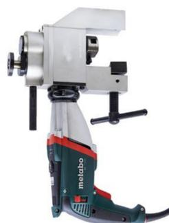
حالت خاصی از کلمپ خارجی می‌باشد که مناسب فضاهای باریک است و مناسب دامنه قطر خارجی ۸ میلی‌متر الی ۱۰۸ میلی‌متر می‌باشد. و در دو حالت فید (پیشروی) اتوماتیک و غیر اتوماتیک قابل انتخاب است.
