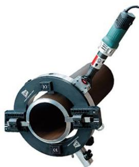
این سری با فرم جداشونده، قابلیت نصب در هر نقطه‌ای از لوله را دارد و دامنه آن، لوله‌هایی با قطر ۱۵ الی ۲۳۱۰ میلی‌متری را می‌توانند پوشش دهند و با توجه به نیاز و انتخاب مشتری امکان سفارش مدل با موتور محرک الکتریکی، پنوماتیکی و هیدرولیکی و حتی Servo Motor را نیز دارند. این سری دارای فید اتوماتیک می‌باشد و همچنین قابلیت ایجاد پخ‌هایی به فرم X.J.V.U را دارد.
