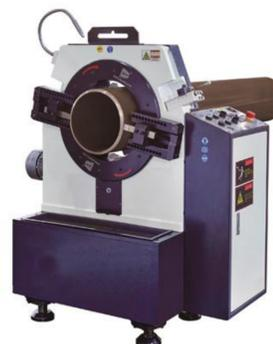
این سری، حالت ایستگاهی دارد و مناسب برای کارهای سری، با تیراژ بالا می‌باشد. دامنه قطرهای این سری ۵۰ میلی‌متر الی ۹۶۵ میلی‌متر می‌باشد و موتور محرک این سری بین حالت‌های الکتریک، پنوماتیک، SERVO MOTOR یا NC قابل انتخاب است.
